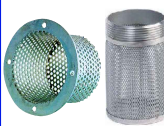
fig 850 : PN16 / staal gegalvaniseerd fig 851 : PN16 / RVS 304 DN50 - DN300 PN16 / RVS 304/316 zeef 1/2" - 4" bsp fig 852 : RVS 304 fig 853 : RVS 316 zeef 1/2" - 2" : 1,0 mm zeef 2 1/2" - 4" : 1,9 mm
