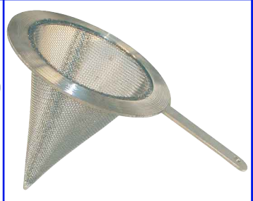
tijdelijke filters fig 849 : RVS 316 of RVS 304 maaswijdte op aanvraag filters worden bij de reiniging van de installatie tijdelijk tussen 2 flenzen geplaatst
