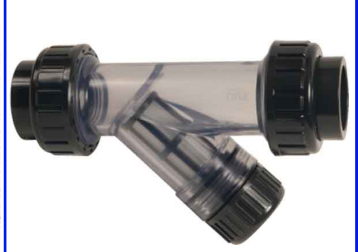
fig 815 : PVC Y-filter PN6 PVC-U huis en koppelingen EPDM dichtingen PP zeef 0,8 mesh max. werkdruk 6 bar temp. : 0°C +50°C lijmeinden of bsp schroefdraad
