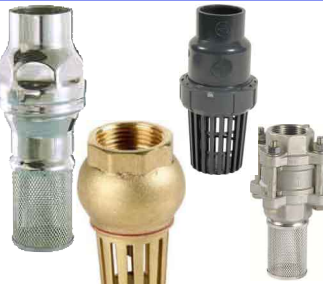
voetkleppen met filterzeef fig 791 : messing/NBR : FF 1/2" - 4" bsp temp. : 0°C +90°C fig 792 : RVS/RVS : FF 3/8" - 4" bsp veer 3-delig huis / temp. : -30°C +200°C fig 793 : RVS/viton : FF 1/2" - 4" bsp veer temp. : -25°C +150°C fig 792 : PVC/EPDM : 20-63 mm lijmeinden veer temp. : 0°C +60°C
