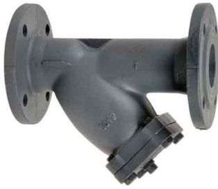
gietijzeren Y-filter PN 10/16 huis : gietijzer / zeef : RVS 304 fig 805 : DN15 - DN400 temp. : -10°C +180°C max. druk 16 bar tot DN200 / 10 bar > DN200 inbouw lengte volgens din 3202 F1 zeef DN15 - DN125 : 1,1 mm zeef DN150 - DN300 : 1,5 mm / 3 mm >DN300
