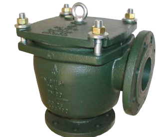
gietijzeren groffilter / haaks model werkdruk : max. 2,5 - 4 bar fig 819 : DN32 - DN400 standaard vierkante gaten 8 x 8 mm snel verwijderbaar deksel huis en deksel in gietijzer oogbout in staal dichting in BNR flenzen volgens PN10
