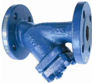
stalen Y-filter PN40 huis : staal / zeef : RVS 304 fig 806 : DN15 - DN200 temp. : -20°C +400°C max. druk 40 bar inbouw lengte volgens din 3202 F1 zeef DN15 - DN50 : 1,0 mm zeef DN65 - DN80 : 1,3 mm / 1,6 mm >DN80
