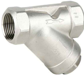
RVS 316 Y-filter PN40 huis : en zeef : RVS 316 fig 804 : FF 1/2" - 2" bsp zeef : 1,0 mm temp. : -30°C +240°C teflon huisafdichtingsring
