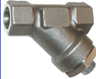
stalen Y-filter PN138 huis : staal A105 / zeef : RVS fig 803 : FF 1/4" - 2" bsp fig 803NPT : FF 1/4" - 2" NPT fig 803SW : FF 1/4" - 2" SW-laseinden temp. : -20°C +440°C zeef : 0,8 mm
