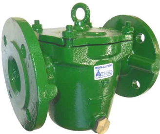
gietijzeren groffilter / recht model werkdruk : max. 2,5 - 4 bar fig 818 : DN32 - DN400 standaard vierkante gaten 8 x 8 mm snel verwijderbaar deksel huis en deksel in gietijzer oogbout in staal dichting in BNR flenzen volgens PN10
