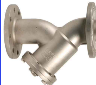
RVS 316 Y-filter PN16 huis : en zeef : RVS 316 fig 807 : DN15 - DN200 temp. : -20°C +200°C max. druk 16 bar inbouw lengte volgens din 3202 F1 zeef DN15 - DN50 : 0,8 mm zeef DN65 - DN80 : 1,0 mm / 3,0 mm >DN80
