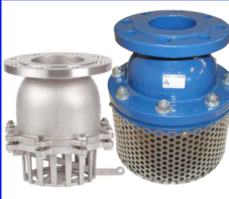
voetkleppen met filterzeef PN16 fig 795 : gietijzeren huis / stalen zeef temp. : -10°C +90°C PN16 : DN50 - DN300 fig 797 : RVS 316 huis en zeef temp. : -25°C +150°C PN16 : DN50 - DN200 manueel leegloop-hendel viton zitting / teflon dichtingen
