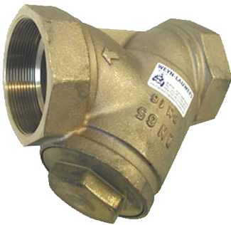
bronzen Y-filter PN16 huis : brons / zeef : RVS 304 fig 801 : FF 3/8" - 4" bsp zeef : 0,4 mm tot 1" zeef : 0,5 mm boven 1" temp. : -10°C +110°C
